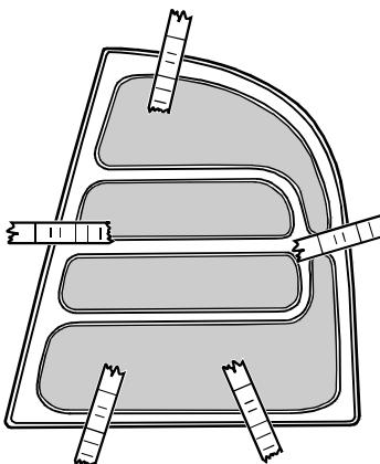
1. Die vorgesehenen Klebeflächen an den Teilen mit dem beiliegenden Schleifpapier leicht aufrauen (Bild 1).
